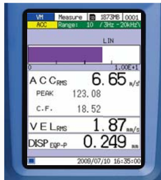
Vibration meter mode
