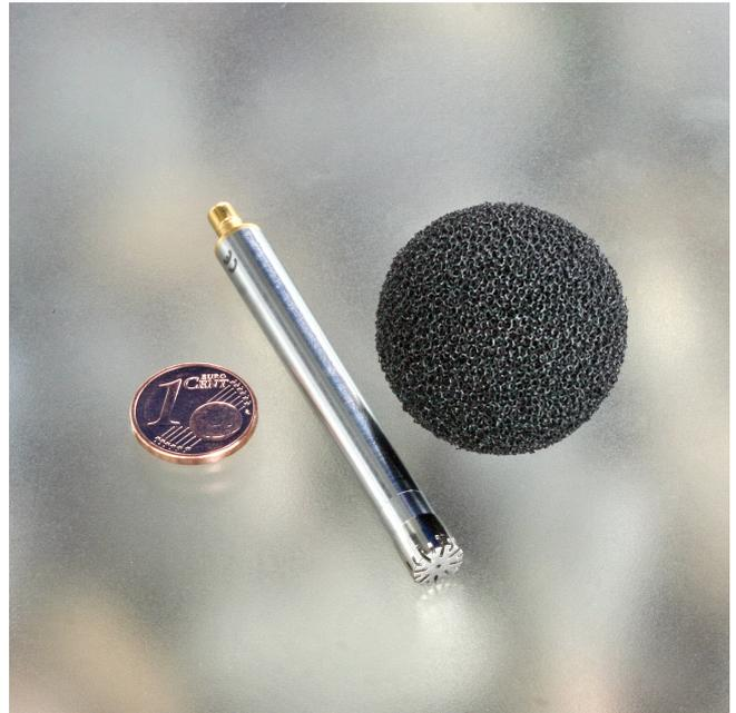
Vorpolarisierte Kapseln mit dauerhafter Polarisation in Form eines vorgespannten Dielektrikums haben den Vorteil, dass sie keine 200V Hilfsspannung für die Polarisation benötigen. Damit ist der einfache Anschluss an konstantstromgespeiste Vorverstärker möglich.
